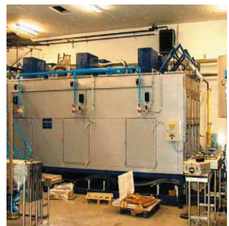
Bild 4: Gasbefuertes Regenerationsofen zur Reaktivierung von 60 CoolKegs pro Stunde
